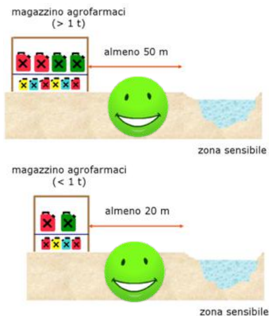
Fig. 11 – Distanza del magazzino degli agrofarmaci da un'area sensibile in funzione della capacità massima di stoccaggio.
