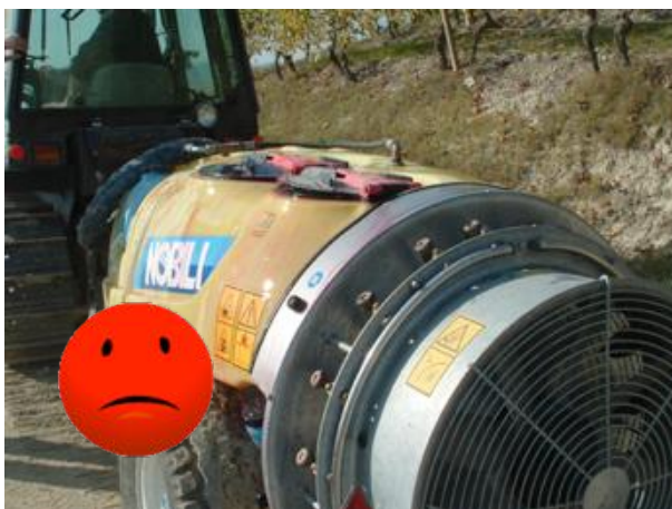
Fig. 8 – Il coperchio del serbatoio deve essere completamente chiuso ed impedire la fuoriuscita del liquido.
