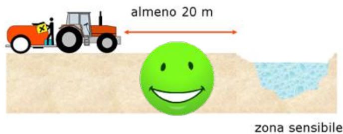
Fig. 55 – Quando si prepara la miscela fitoiatrica è necessario operare almeno ad una distanza di 20 metri dai corpi idrici.
