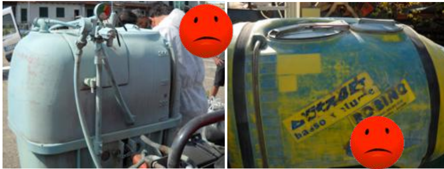
Fig. 79 - Non rimuovere i depositi esterni accumulatisi sull'irroratrice subito dopo aver eseguito il trattamento può comportare un'elevata contaminazione dell'area dove la macchina viene ricoverata, può danneggiare parti dell'attrezzatura e può rappresentare un pericolo per le persone.
