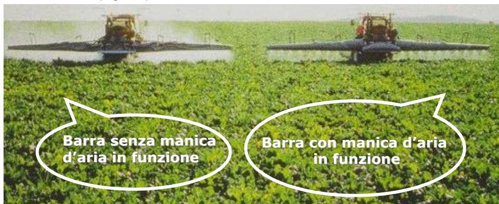
Fig. 155 – Distribuzione senza e con attivazione della manica d'aria.
