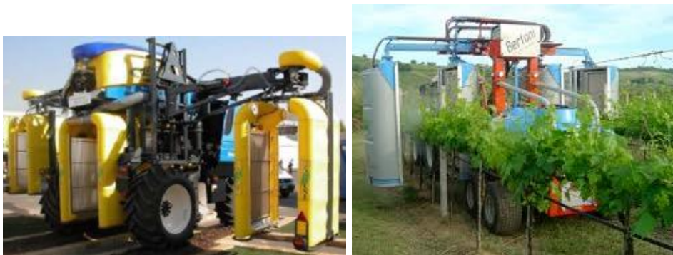
Fig. 163 - Esempi di irroratrici con sistema di recupero del liquido che oltrepassa il filare.
