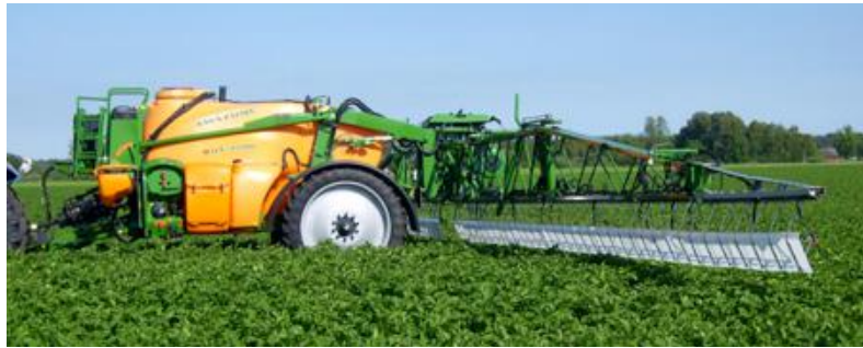
Fig. 157 – Il crop tilter apre la vegetazione per favorire una migliore penetrazione delle gocce (foto: http://www.vibyteknik.se )
