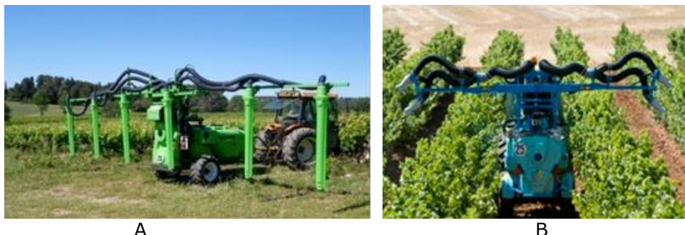
Fig. 183 - Irroratrice scavallante: A) con ugelli a polverizzazione idraulica; B) con diffusori pneumatici.
