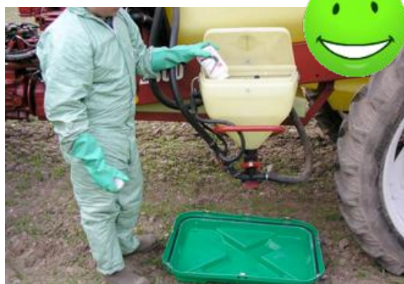
Fig. 60 – Esempio di soluzione atta ad evitare possibili fonti di inquinamento puntiforme durante la preparazione della miscela fitoiatrica (Foto Harper Adams).
