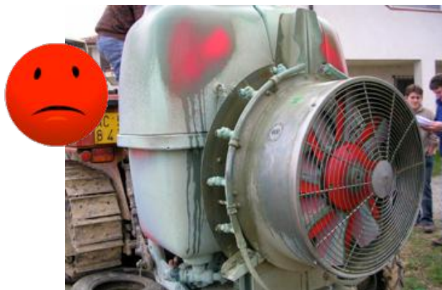
Fig. 35 - Esempio di macchina irroratrice in cui il getto erogato colpisce il serbatoio determinando il gocciolamento a terra della miscela fitoiatrice e causando, quindi, inquinamento puntiforme.
