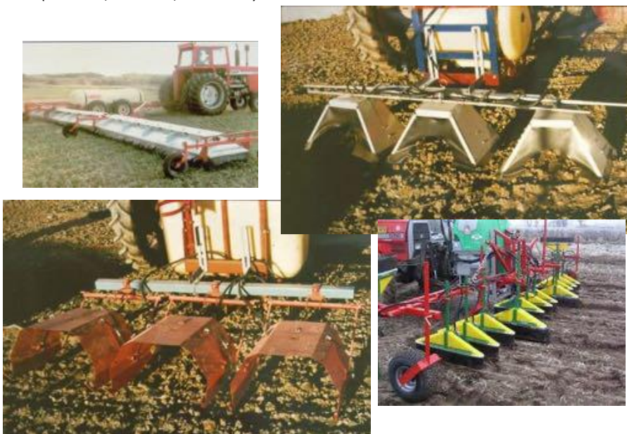
Fig. 122 – Esempi di schermature su barre irroratrici.
