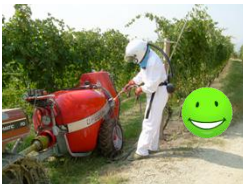
Fig. 81 – Lavaggio esterno della macchina irroratrice in campo al termine del trattamento utilizzando una lancia e l’acqua del serbatoio lavaimpianto.
