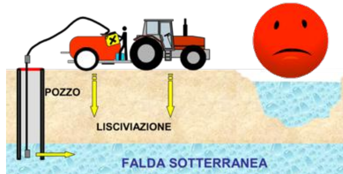
Fig. 56 – Prelevare l'acqua direttamente da un pozzo (o da un corso d'acqua superficiale) durante il riempimento dell'irroratrice può determinare inquinamento delle acque
