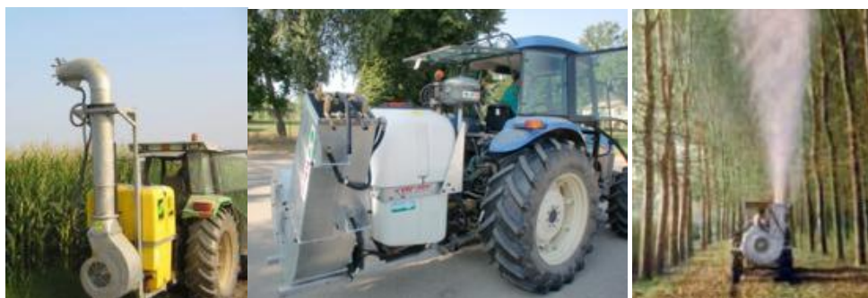
Fig. 181 - Esempi di irroratrici a cannone, molto sensibili alla deriva
