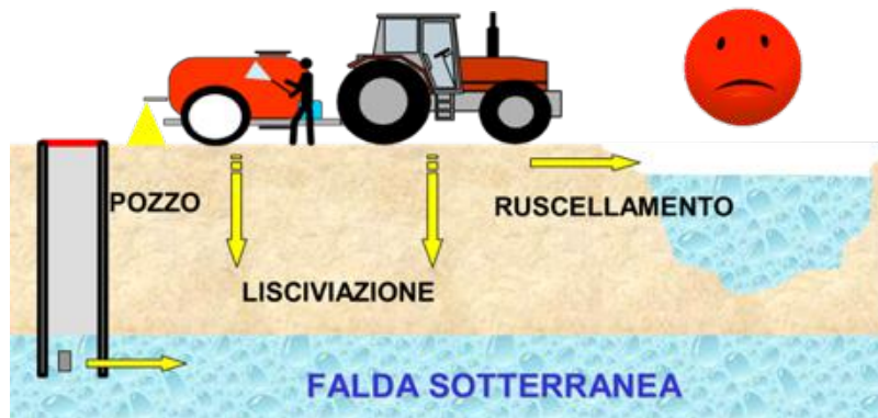
Fig. 87 - Effettuare il lavaggio dell'irroratrice e lo smaltimento della miscela residua a fine trattamento in prossimità di un corpo idrico può determinare inquinamento delle acque.
